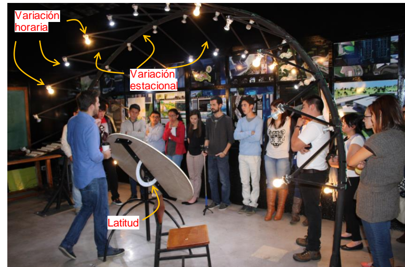
Mecanismos de movimiento del Heliodón URL Fuente: Elaboración propia
