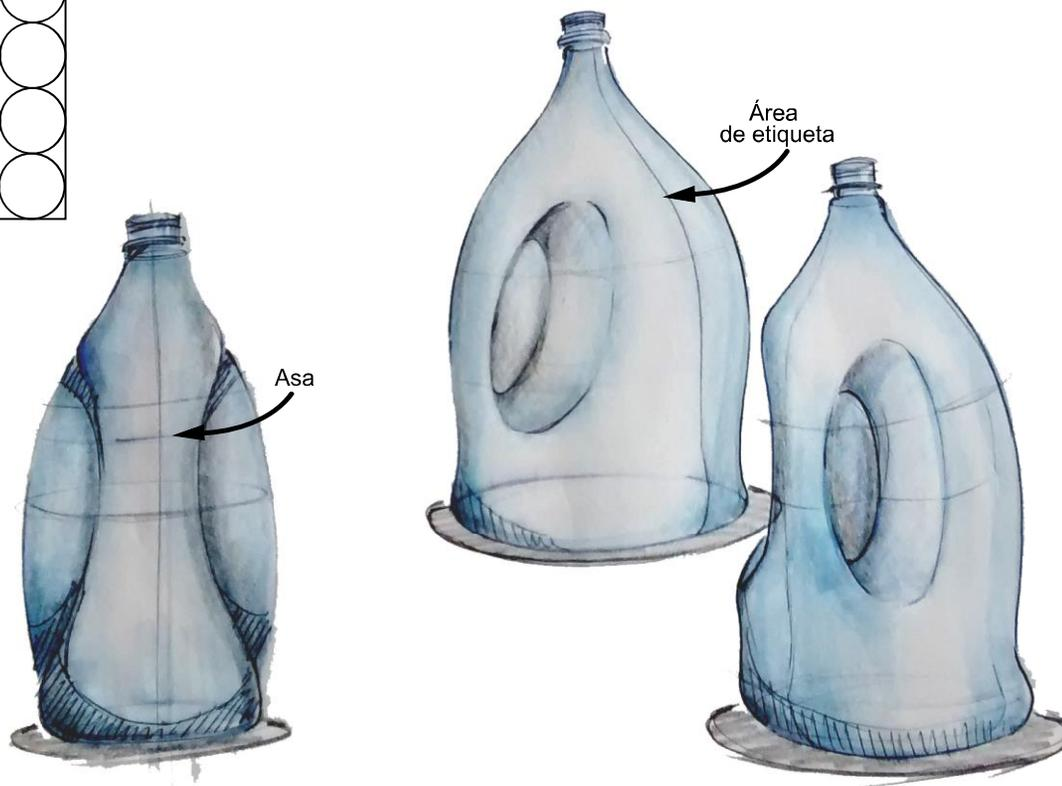
Diseño de envase de base circular, posee un asa grande que abarca la mayor parte del envase. No tiene costillas que den estructura al envase. Las dimensiones aproximadas son de  $\varnothing$  150 x 300 mm.
