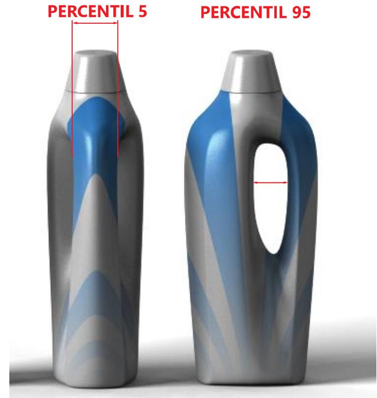
DESCRIPCIÓN: PERCENTILES UTILIZADOS EN EL DISEÑO DEL ENVASE PET CON ASA INTEGRADA
