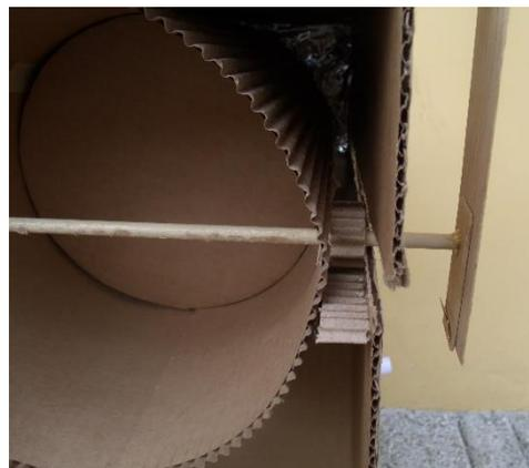
Mecanismo de extrusión: cremallera y piñón. Este mecanismo permite que una placa avance en el interior de la cavidad de la masa, haciendo que esta salga por los agujeros frontales.
