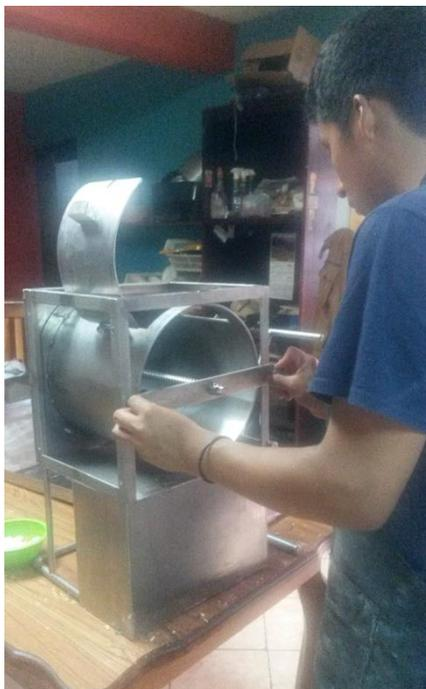
Retirar la pieza de seguridad posterior y el disco de avance por medio de las mariposas laterales
