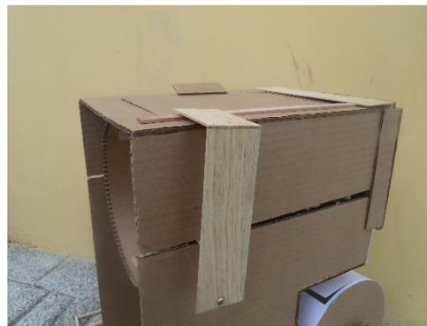
El mecanismo de extrusión está conectado al mecanismo de corte por medio de una biela.
