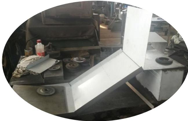
7. Realización de angulares para refuerzo de estructura
