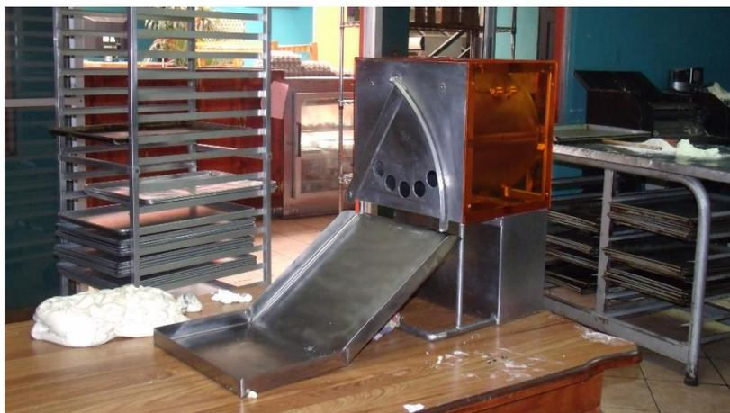
Figura 64, Máquina boleadora en su ambiente de trabajo.
