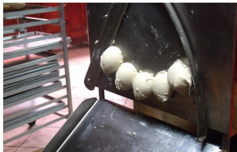
Figura 65, bolitas de masa de pan francés antes de ser cortadas por la cuchilla.
