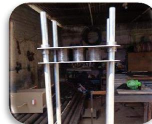
5. Base 1 también se colocó adentro de la estructura, y a esta se le fijaron (soldaron) las bases de molde, quedando así alineadas con los moldes ya colocados.
