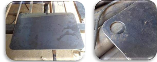
2. Los sobrantes de los círculos cortados de la bandeja 2 se redujeron para utilizarlos como la base de los moldes de la bandeja 1.
