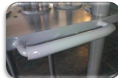
17. Se cortaron y soldaron 3 manivelas. A estas manivelas se les agrego un tubo de mayor diámetro al centro, y a dicho tubo se le realizaron los agujeros para insertar tornillos. A cada manivela se le coloco su respectivo mango de timón.
