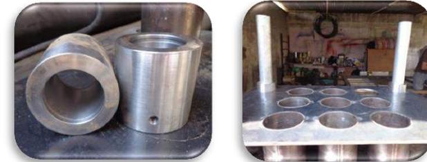
4. Se soldaron tubos de estructura a una base temporal (para que estos quedaran alineados), y dentro se colocó la bandeja 2, dejándola fija por medio de soldadura.
