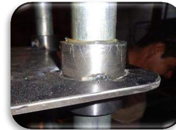
8. Se soldó bandeja 4 a estructura. A esta bandeja se le realizo un corte rectangular para poder colocar el mecanismo piñón-cremallera.
