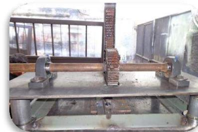
12. Al tener el mecanismo funcionando, se soldaron los tubos para aplicar presión a la bandeja 3.
