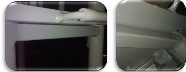
14. Se realizaron los soportes de la bandeja 1 por medio de cortes y dobleces. A estos soportes se les agregaron agarradores de manguera. Luego se realizaron agujeros en el tubo de la estructura. En esos agujeros se insertan los soportes.
