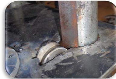
7. Bandeja 3 se le colocaron los respectivos bushings, y la misma se colocó dentro de la estructura.
