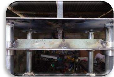
11. Se armó el mecanismo. Esto consistió la colocación de las chumaceras en la bandeja 4, y la colocación del eje giratorio a través de las chumaceras y el piñón.
