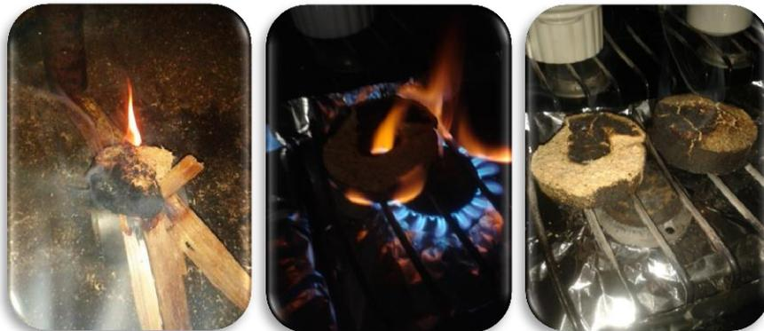
1. Quemado de briqueta con ocote y soplete
