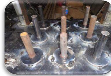
6. A tubos de estructura de les soldaron rieles y a la bandeja 1 se soldaron rodos en V, los cuales permiten que la bandeja 1 sube y baje.
