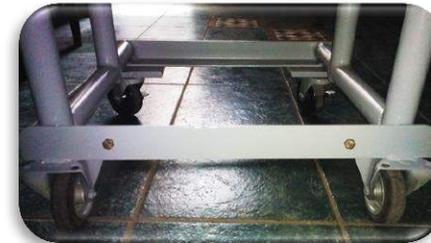
19. Se fabricaron 2 estabilizadores para la parte inferior de la máquina, y así poder colocar esta de manera fija.
