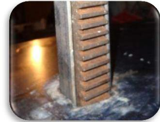
10. Se agregaron soportes requeridos a la bandeja 3, para luego unir por medio de soldadura dicha bandeja a la cremallera.
