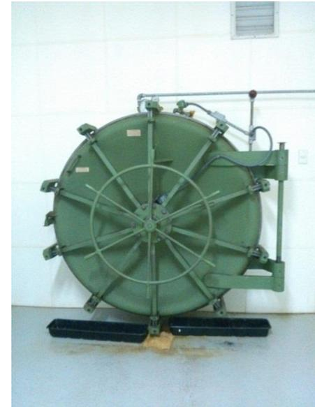
**Imagen 26.** Autoclave para esterilización de bolsas.
