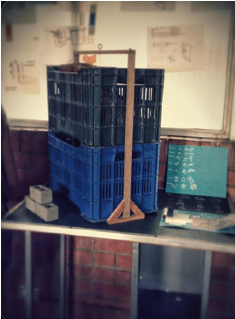
Se presenta la primera propuesta para el remojo de bloques, la cual consiste en dos barras de aluminio que sujetan las canastas y se aseguran con una barra lateral en su parte superior. Este puede transportarse con poleas sumergirse en una cisterna, reduciendo así los esfuerzos a la hora colocarlos.
