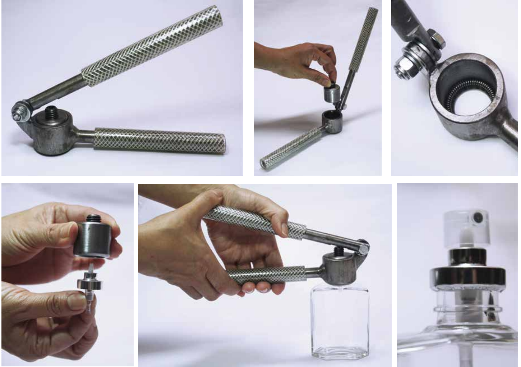
Figura 17. Proceso de sellado de pinza selladora. Fuente: propia
