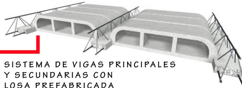
SISTEMA DE VIGAS PRINCIPALES Y SECUNDARIAS CON LOSA PREFABRICADA (VIGUETA Y BOVEDILLA)
