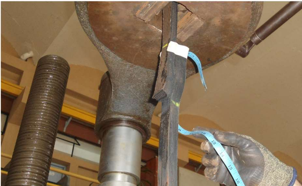
Figura 48. Inicio del ensayo de tensión
