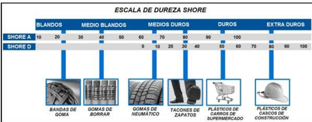
Figura 54. Escala de Dureza Shore A
