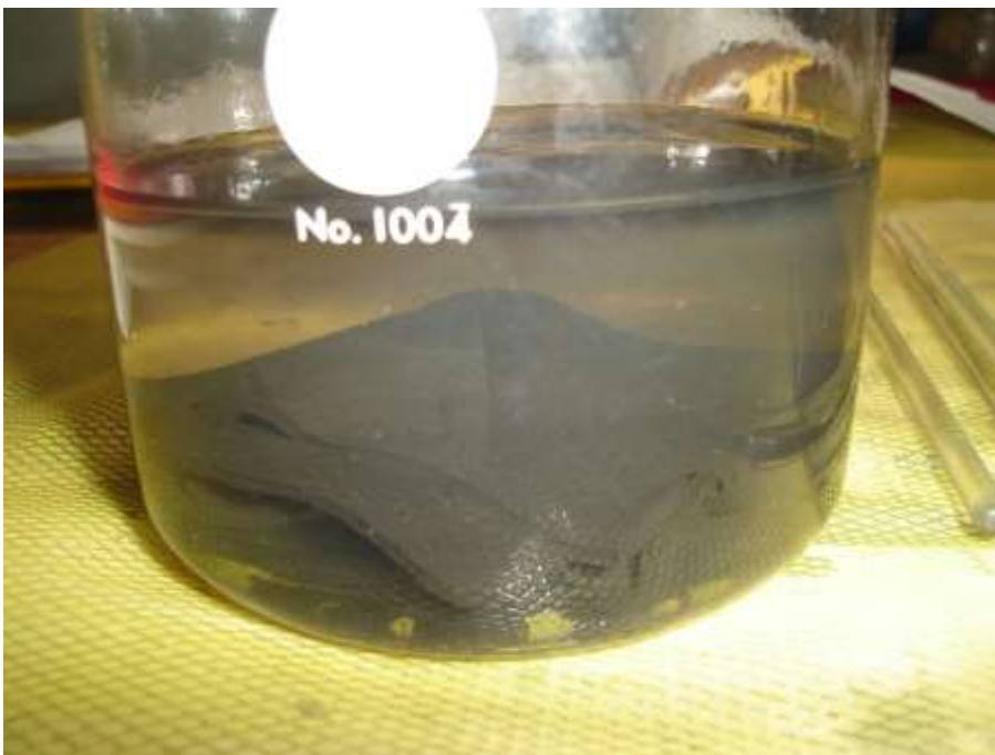
Figura. 61. Disolución del hule natural en el solvente.
