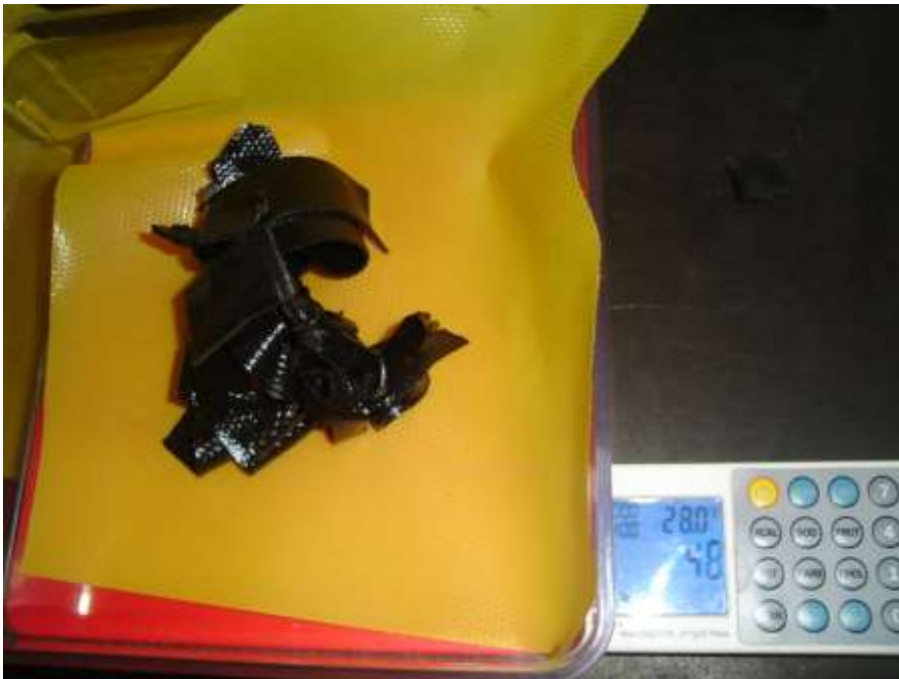
Figura. 61. Disolución del hule natural en el solvente.
