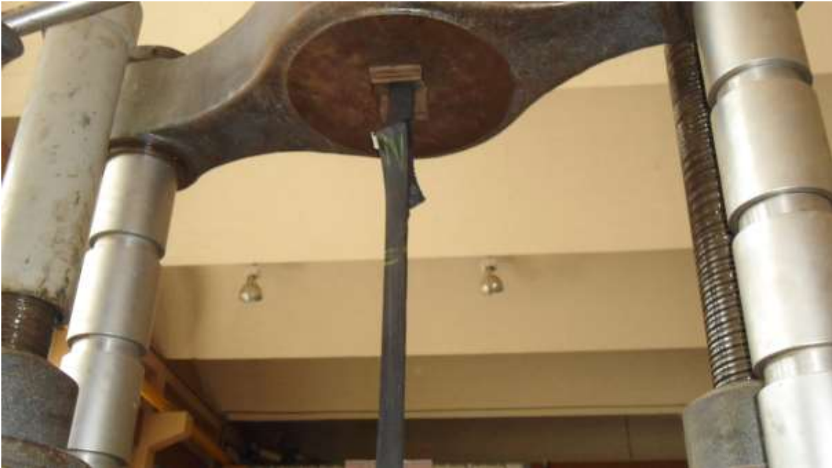
Figura 49. Momento antes de la falla en la sección de unión durante el ensayo de tensión.
