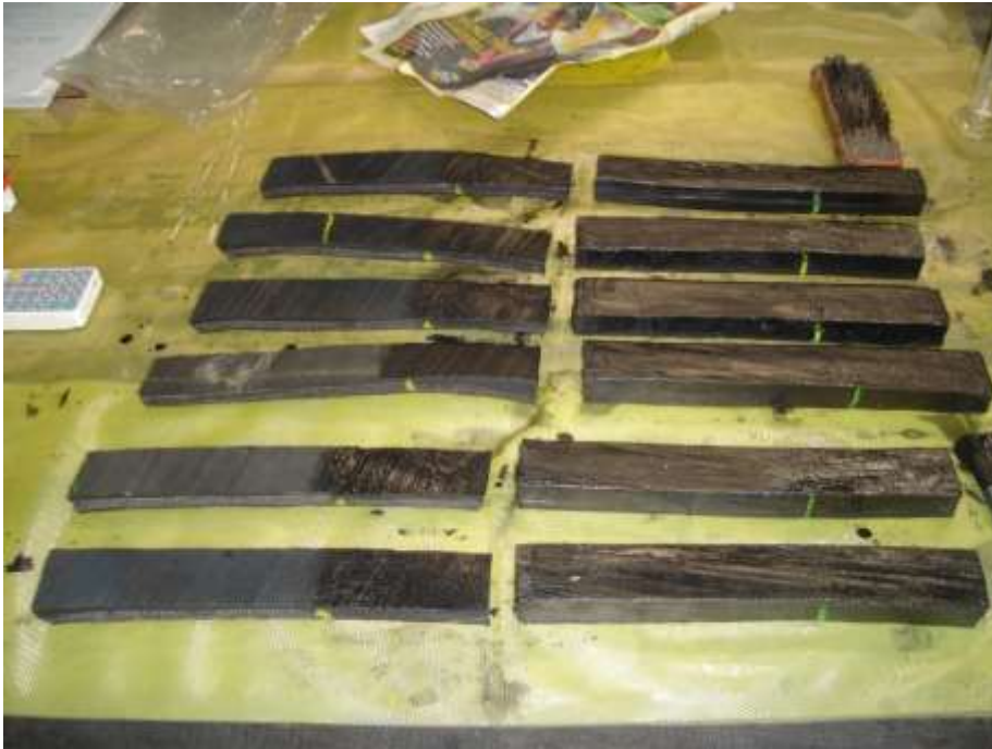
Figura. 64. Adición de adhesivo a probetas.
