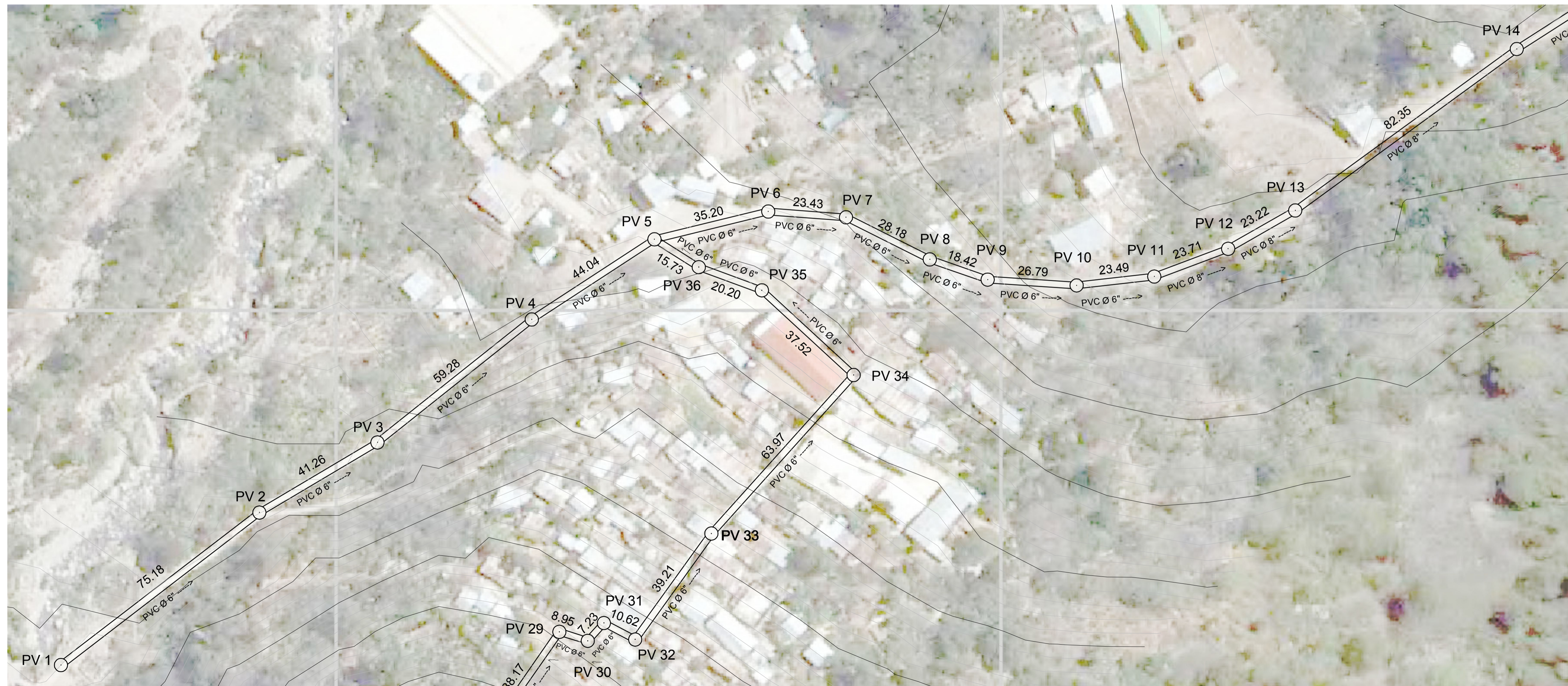
Planta Sector 1 - Linea 1 (PV1 - PV14)
