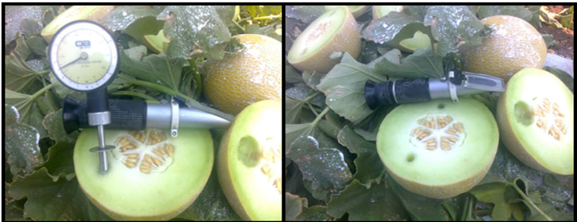
Figura 11. Instrumentos de medición de Grados Brix y psi.
