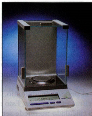
Balanza de laboratorio estándar. Este tipo de balanzas permite determinar la masa de un objeto con precisión de miligramos. De este modo, un objeto puede tener una masa de 13.456 g (13 456 mg, cinco cifras significativas), 0.123 g (123 mg, tres cifras significativas) o 0.072 g (72 mg, dos cifras significativas). (Charles D. Winters)
