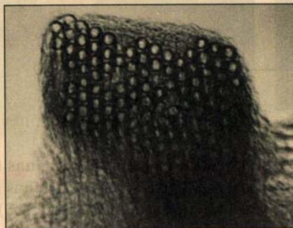
Macizo de nanotubos de carbono. Cada tubo tiene un diámetro de 1.4 nm, y el macizo tiene 10-20 nm de espesor. (P. Nikolaev, Universidad de Rice, Centro de ciencias y tecnologías a escala nanométrica)
