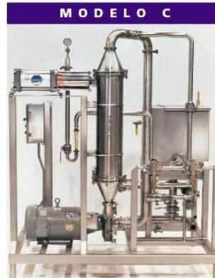
Planta piloto de microfiltración con membranas cerámicas
