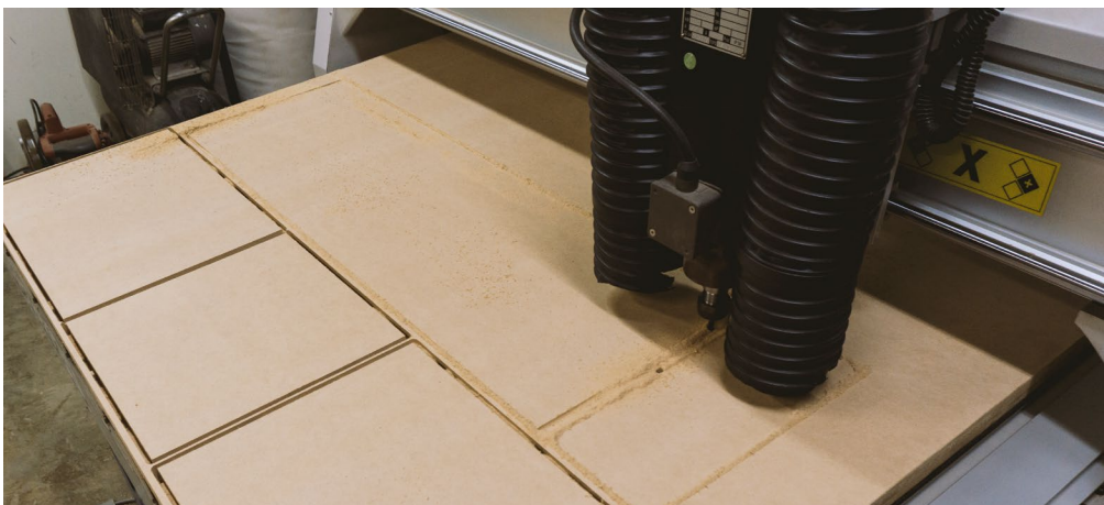
Figura 196. Operación de corte en máquina CNC.
