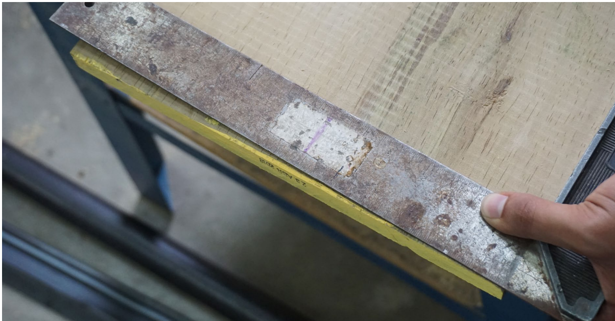
Figura 207. Verificación con escuadra de ángulo incorrecto.
