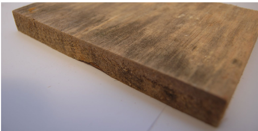
Figura 36. Coloración azul producida por el hongo cromógeno en la madera aserrada.
