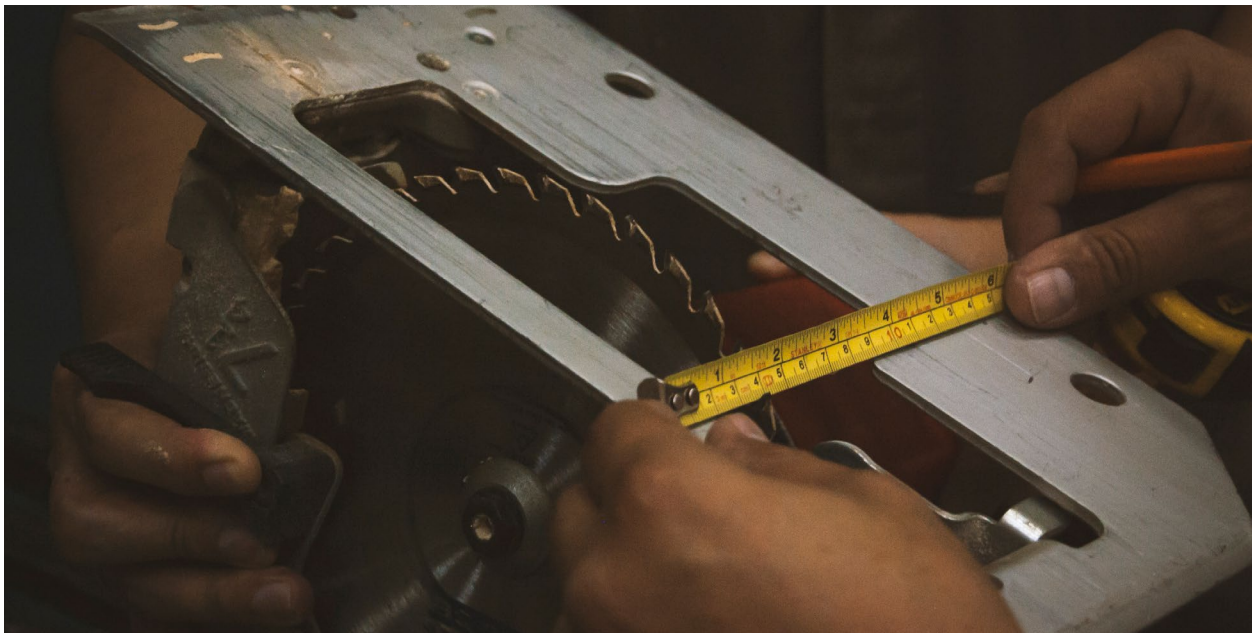
Figura 183. Medición del espesor de la sierra dentada.
