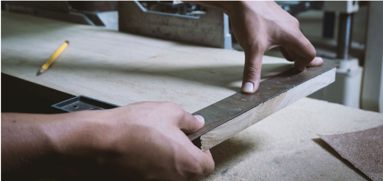
Figura 208. Verificación con escuadra de ángulo correcto.
