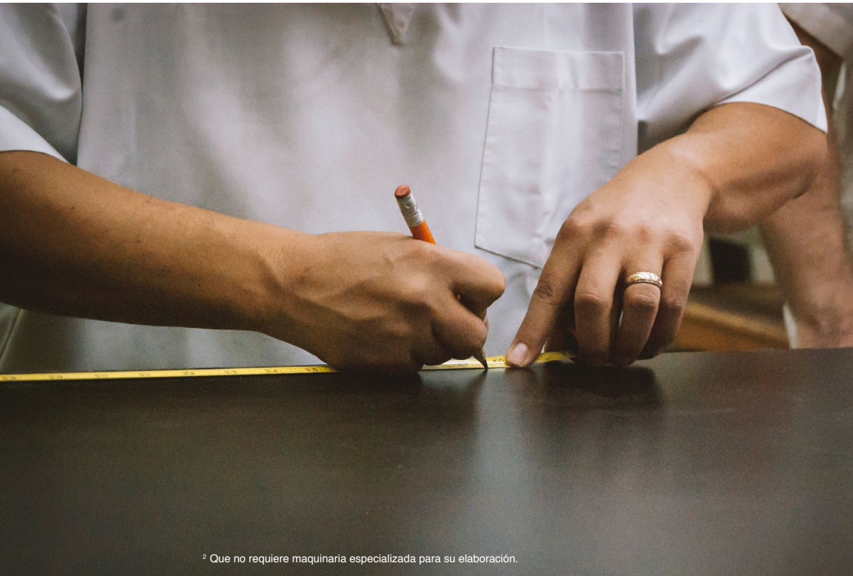
Figura 182. Medición y trazado de piezas, sobre tablero de melamina.
