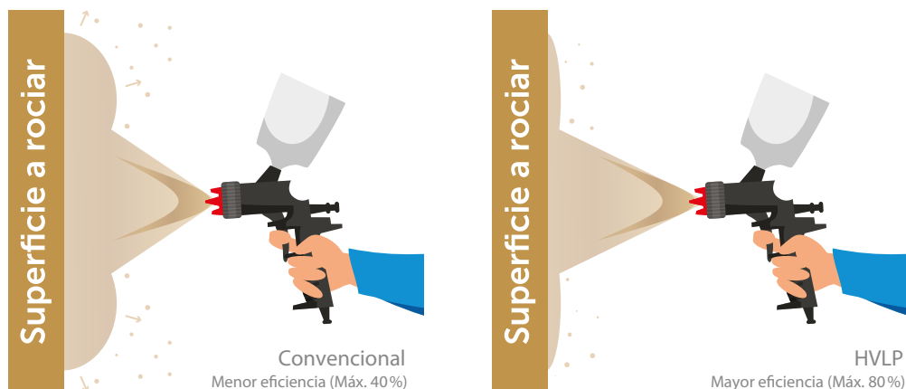
Figura 171. Diagrama explicativo de la diferencia entre estos dos métodos de aplicación.
