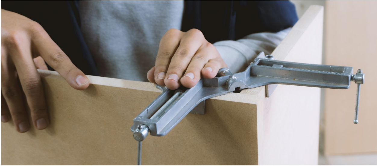
Figura 198. Ensayo de unión con prensas esquineras.
