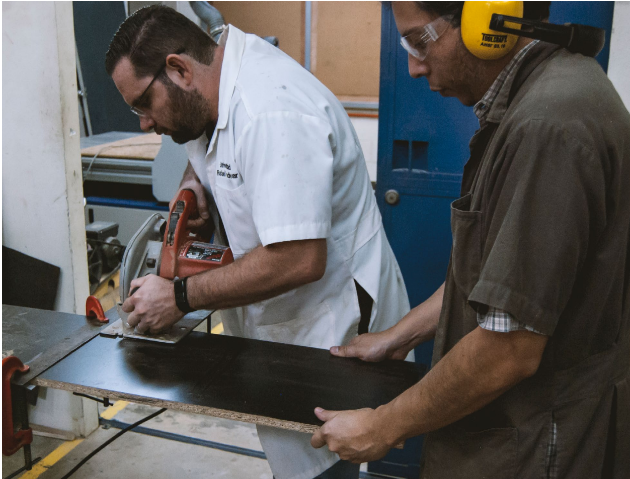
Figura 186. Proceso de corte de piezas con sierra circular.
