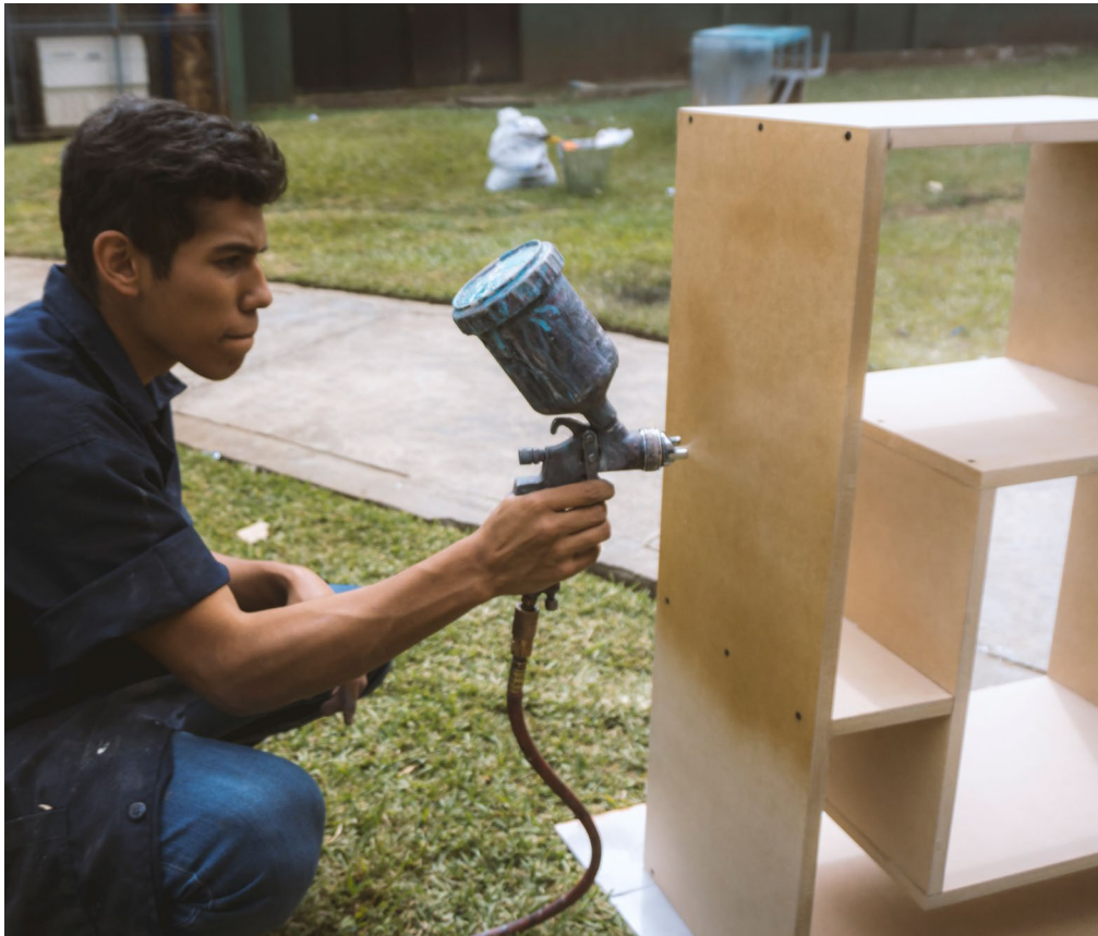
Figura 205. Aplicación de sellador con pistola a presión.
