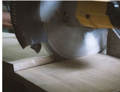
Figura 210. Corte con sierra de máquina ingleteadora.
