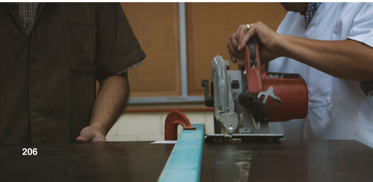
Figura 184. Reducción del tablero de melamina con sierra circular.
