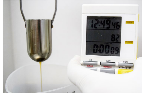
Figura 172. Medición de viscosidad.
