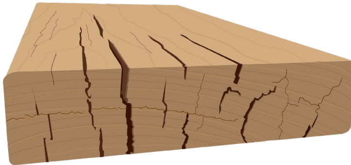
Figura 26. Rajadura en la madera.
