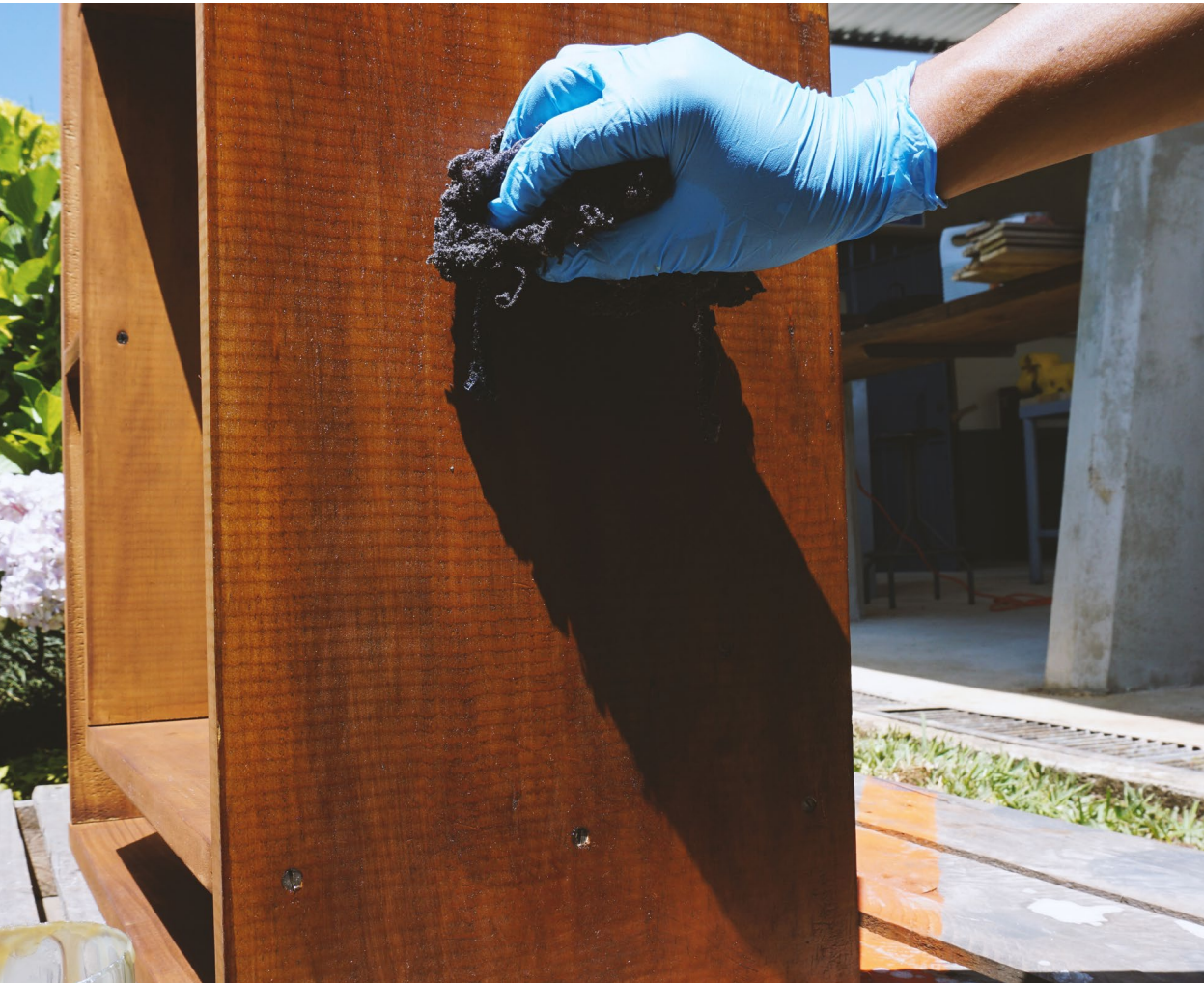
Figura 217. Aplicación del sellador al mueble de pino.
