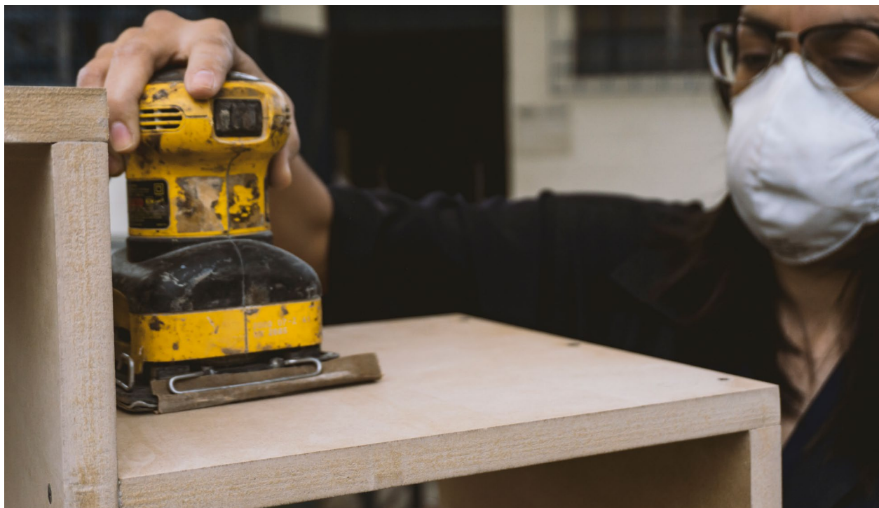
Figura 201. Preparación de la superficie con lija de grano número 500 y lijadora orbital.
