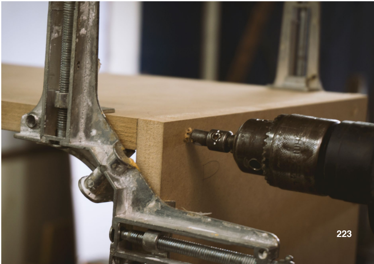
Figura 200. Perforación con broca de 5/8" y avellanadora.
