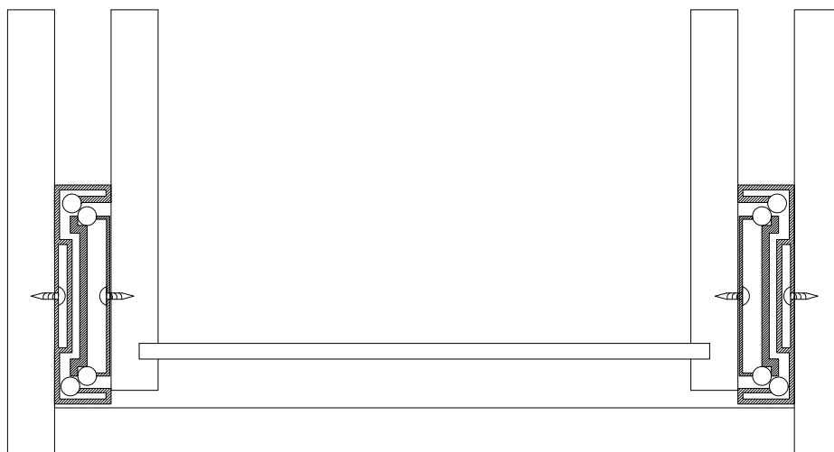
Figura 132. Corredera extensión instalado en gabinete. Vista frontal.
