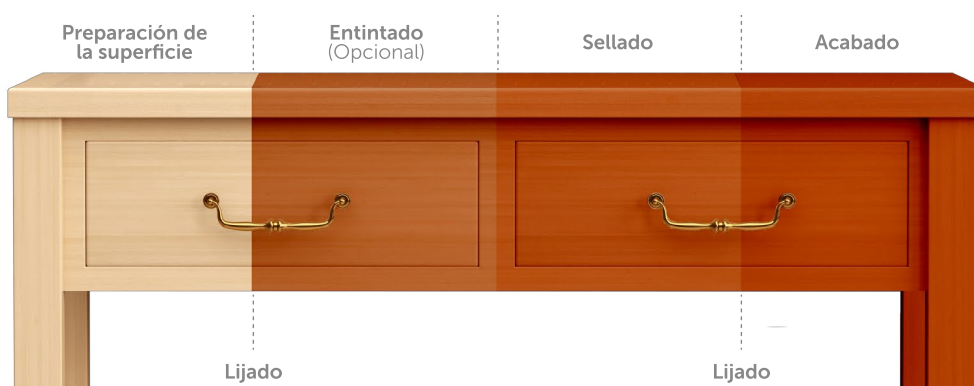
Figura 148. Esquema de un sistema de acabado típico en madera.
