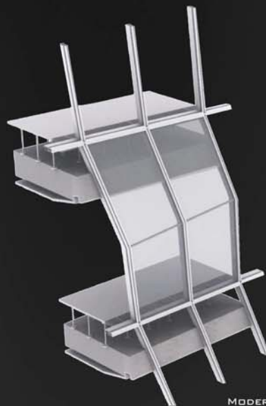
ARRIBA: SE MUESTRA UN EJEMPLO ESTRUCTURAL, DEL TIPO DE VANTANA USADO, EXHIBIENDO LOS DISTINTOS ELEMENTOS DE LA VENTANERÍA Y EL COMO A UTILIZAR LOS MARCOS Y PANELES INDIVIDUALES DE VIDRIO, AJUSTANDO LOS QUIEBRES DE LAS VENTANAS PARA ENCAJAR EN LA GEOMETRÍA DEL VOLUMEN.
