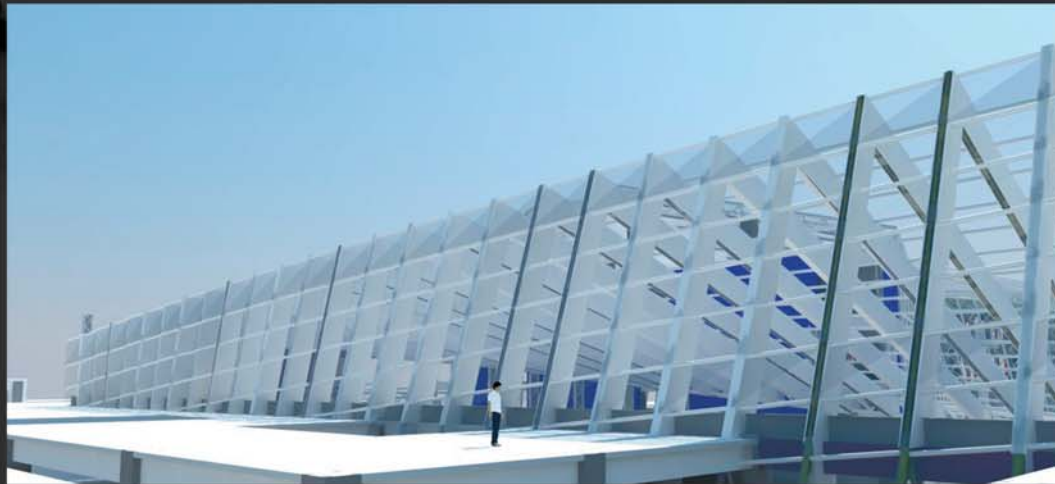
VISTA DEL TECHO ACRIALADO DEL ATRIO PRINCIPAL Y SU ESTRUCTURA
