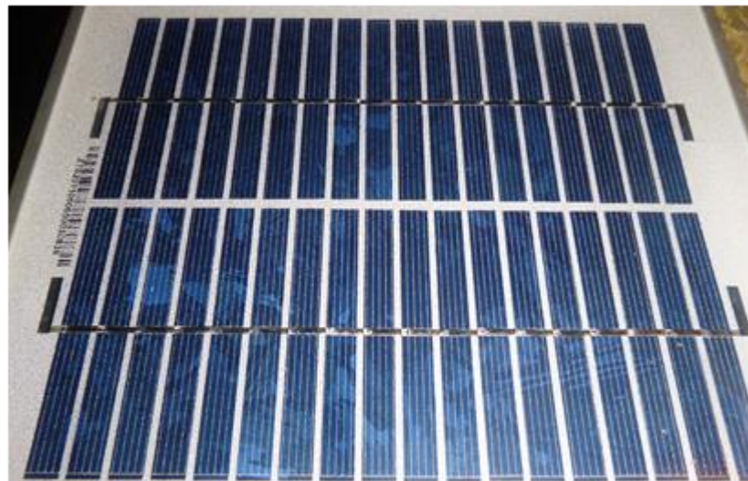
Fuente: elaboración propia 2012, en base a Erick González. Panel Policristalino Zytech modelo ZT3P de 3 watts. Quetzaltenango.
