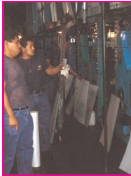
Fotografía 18. Colocando placas en respectiva unidad. . Lugar Prensa Libre. Depto. Impresión.
