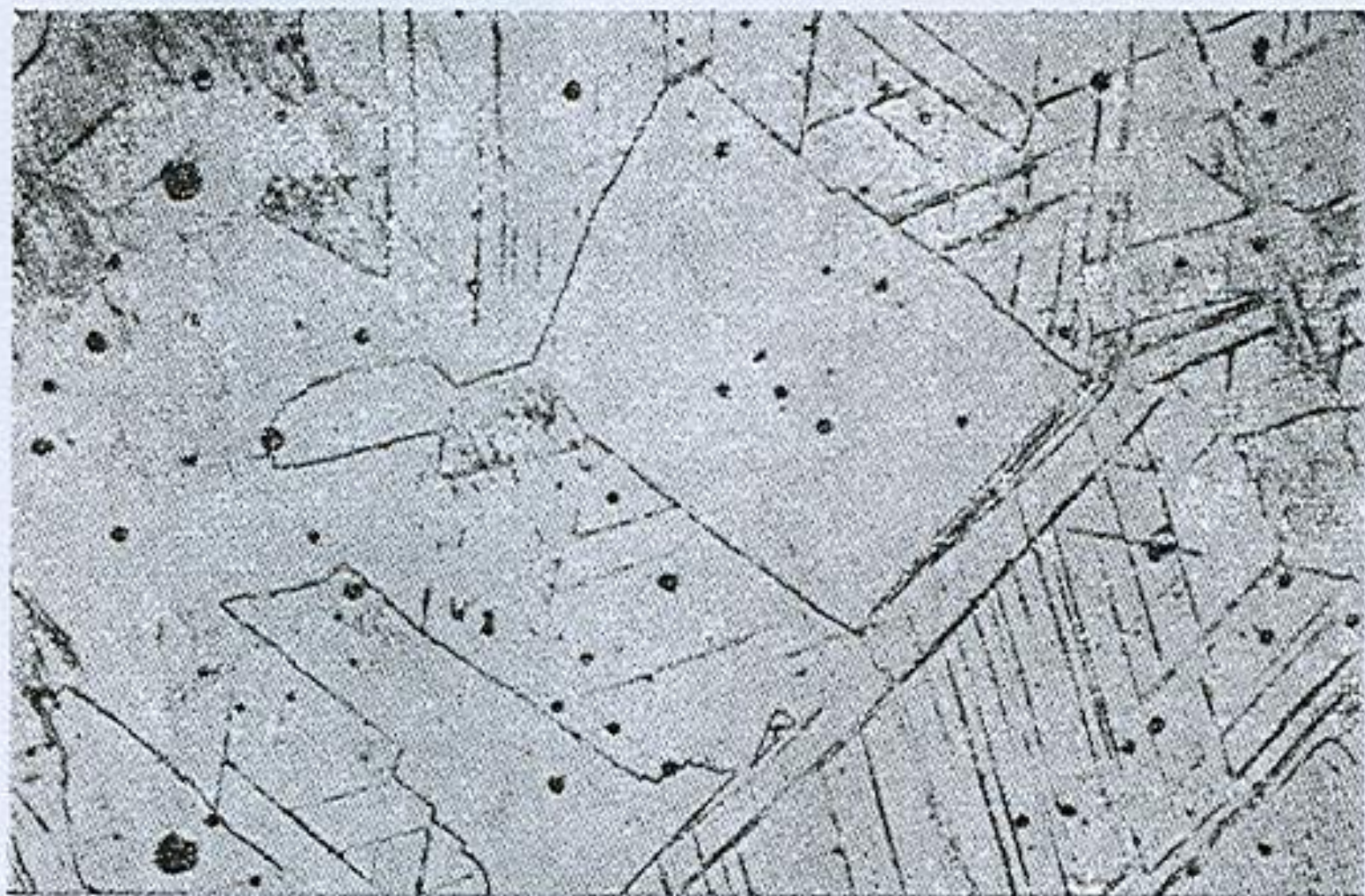
Fig. 19-13. — Austenita x 200. Ataque electrolítico con ácido oxálico al 10 %. Las maclas visibles en la estructura corresponden a deformaciones de orden mecánico de la red cristalina.
