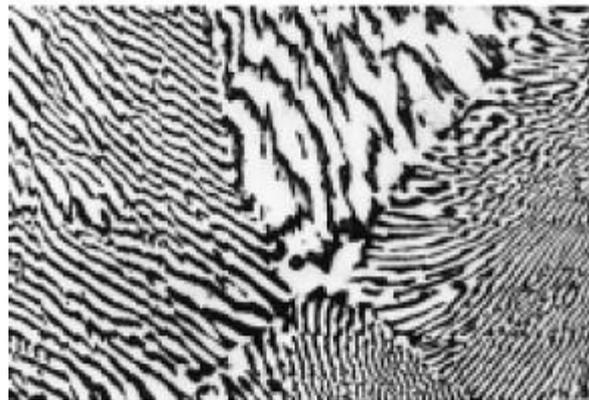
Fotomicrografía que muestra la estructura de la aleación Pb-Sn de composición eutéctica. Esta microestructura consiste en capas alternas de una fase α de solución sólida rica en Pb (Capas Oscuras) y una fase β de solución sólida rica en Sn
